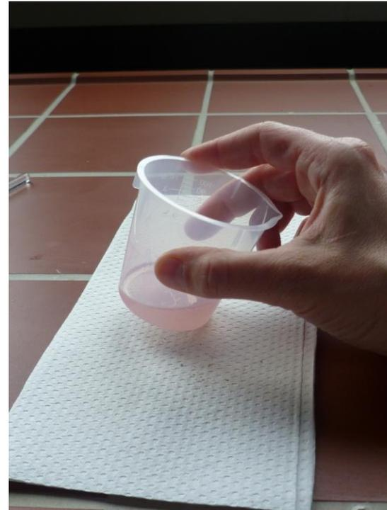
Durch vorsichtiges Rühren und leichtes Klopfen auf die Tischoberfläche treibt man den größten Teil der Gasbläschen aus der Polymer-Masse.
