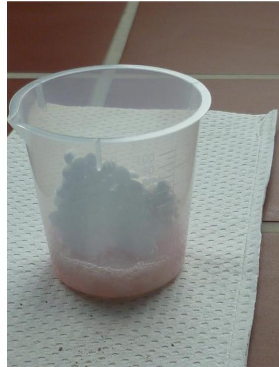
In der Spiropyran-Toluol-Lösung löst man insgesamt 3,5-4 g Styropor in kleinen Stücken, bis eine zähflüssige aber noch gießfähige Masse entsteht.
